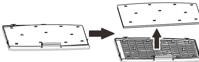
3. Sostituire con un modulo filtro nuovo o rimettere il filtro nel coperchio.
