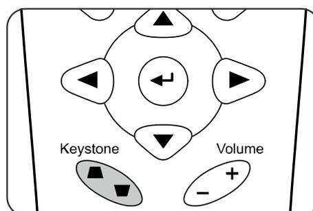
3. Sullo schermo appare il controllo della distorsione.
